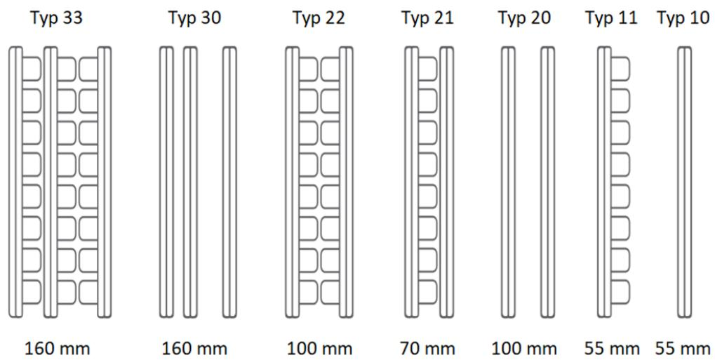
Typ: 1. Ziffer = Anzahl der Heizplatten 2. Ziffer = Anzahl der Konvektoren
